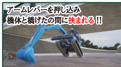
事例集② 治山林道工事編 「橋げたとバックホウの間に挟まれ」より
